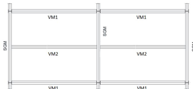
Figura 5 - Layout de um pavimento com uso do sistema Stub-Girder modificado.
