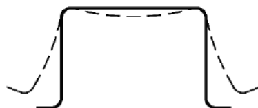
Figura 1 - Fenômeno da flambagem distorcional
