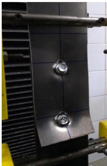
Figura 11 - Modo de falha da ligação com esmagamento da chapa 1
