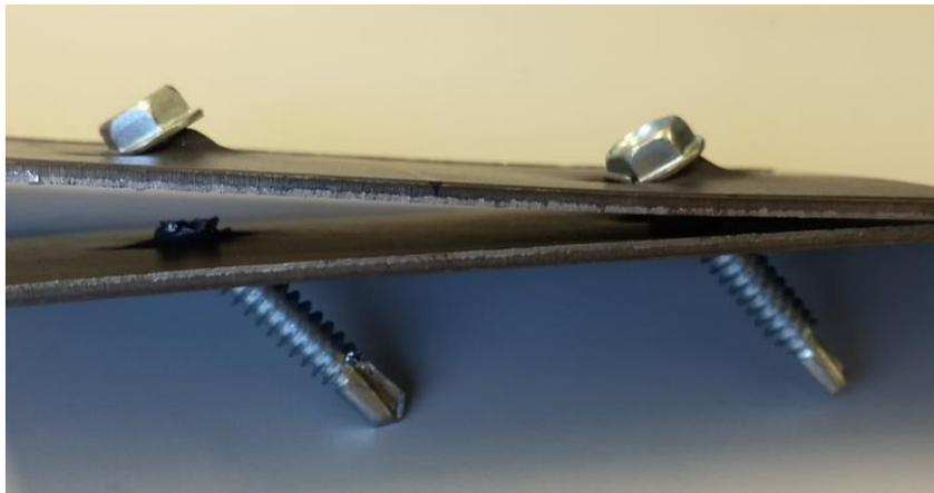
Figura 9 – Falha por cisalhamento do parafuso
