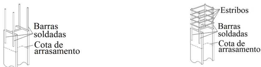
Figura 11 – Esquema da ligação da estaca com o bloco por armaduras complementares
