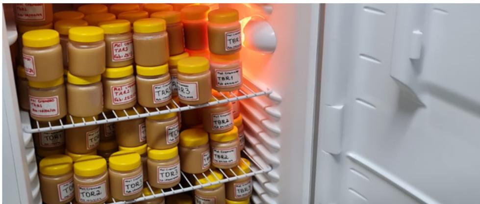
**Figura 17 - Armazenamento em BOD a 14°C para finalizar a cristalização induzida**
