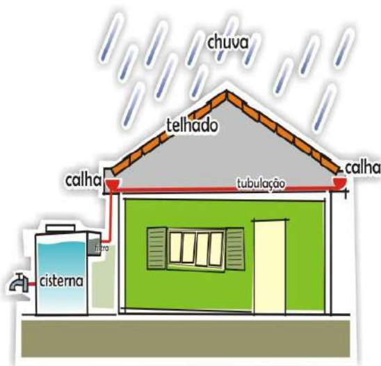
Figura 1: Esquema de um sistema de captação de água de chuva
